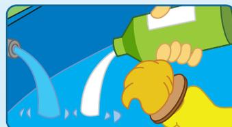
**9.** Quando a caixa estiver seca e com a saída ainda fechada, deixe entrar um palmo de água e adicione 2 litros de água sanitária (esta proporção é para uma caixa d'água de 1.000 litros).
